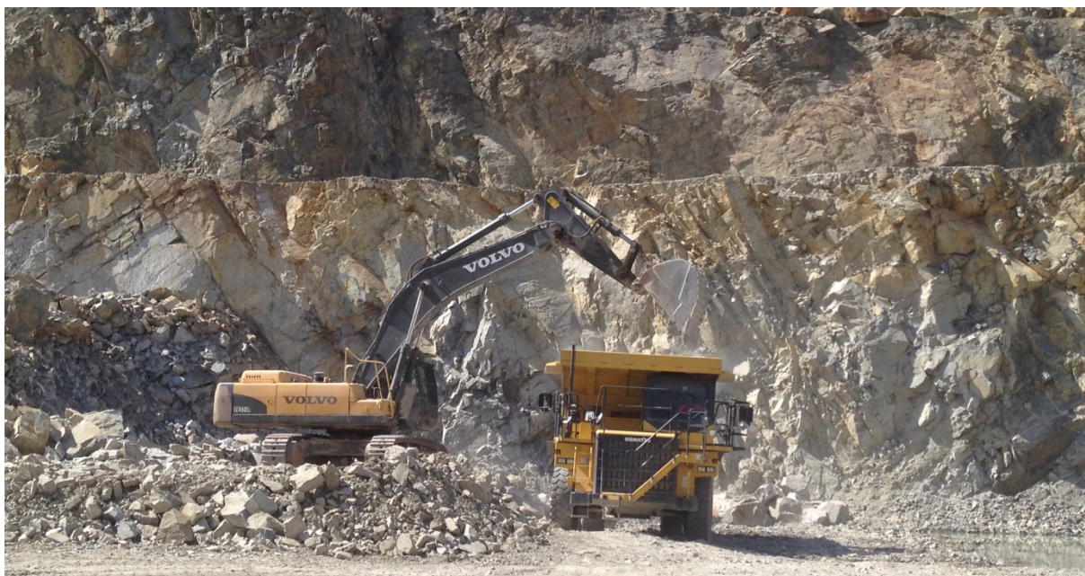
Figure 13 - Opération de reprise du matériau en pied de front
